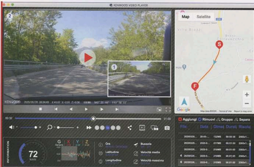
La schermata del programma per computer che mostra tutti i dati memorizzati nella card, i video anteriore e posteriore sincronizzati, la posizione dell'auto sulla mappa e tutti i dati relativi all'accelerometro, al GPS e alla gestione dei file.
